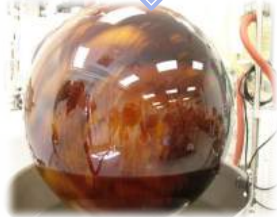
ระเหยตัวทำละลายด้วย Rotary evaporator
