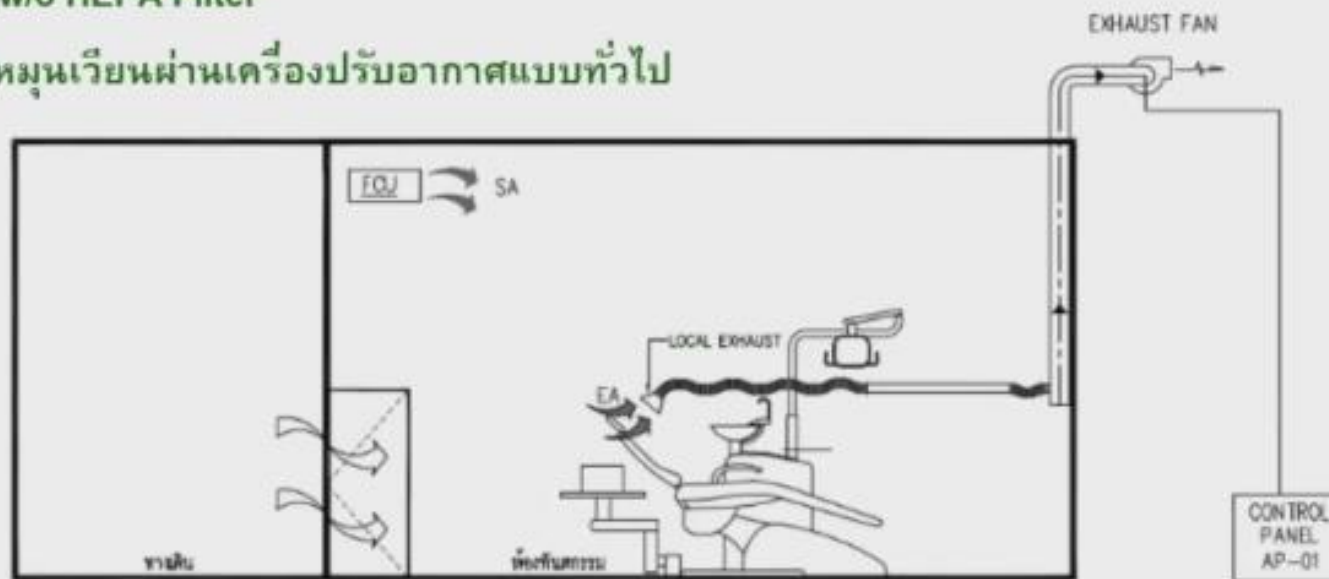
ไดอะแกรมระบบระบายอากาศสำหรับห้องทันตกรรมทั่วไป
